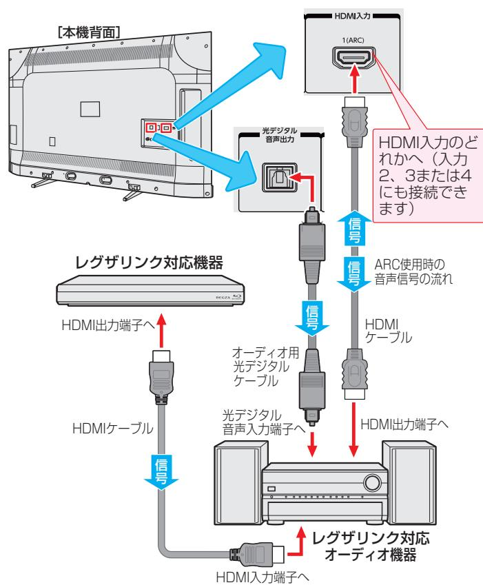
※ ARC対応のオーディオ機器を、ARC対応のHDMIケーブルでHDMI入力1(ARC)端子に接続する場合は、光デジタルケーブルの接続は不要です。
