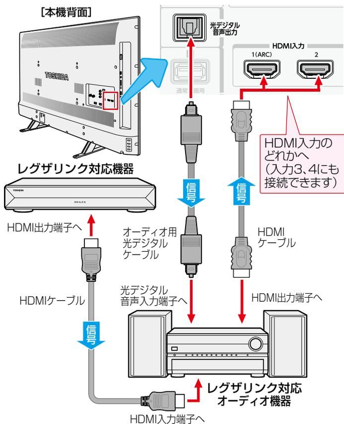
※ ARC対応のオーディオ機器を、ARC対応のHDMIケーブルでHDMI入力1 (ARC)端子に接続する場合は、光デジタル音声ケーブルの接続は不要です。
