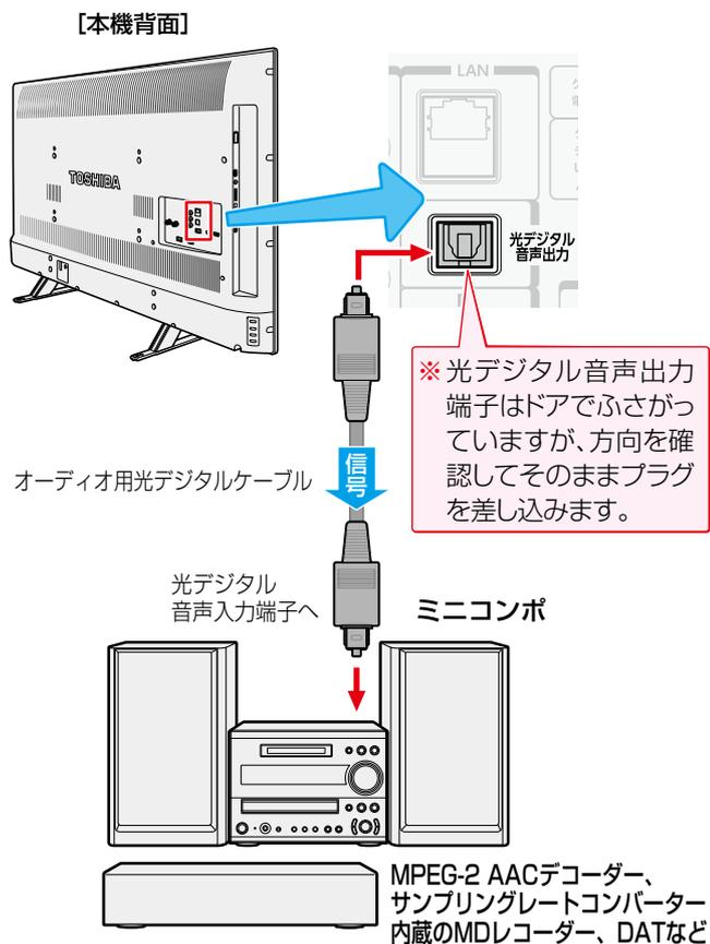
※ 光デジタルケーブルのプラグには2種類の形状があります。接続する機器の端子形状に合ったケーブルをお買い求めください。本機側に差し込むプラグの形状は、
