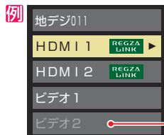
お買い上げ時の設定では、機器が接続されていないビデオ入力は薄くなって表示され、入力切換時にスキップされるようになっています。(「外部入力スキップ設定」(準備編)**59**で変更することができます)
