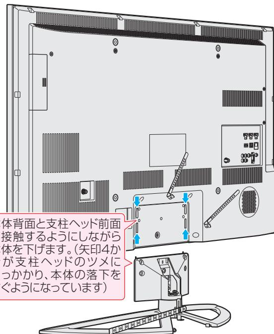
\* ネジで固定するまでの間、不意の転倒・落下を防ぐために本体を支えてください。
