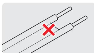
● 壁のアンテナ端子はネジ式の端子が突き出たタイプをおすすめします。平行フィーダー用のアンテナ端子①や接続部分がむき出しのアンテナ端子②は、受信障害の原因になることがあります。交換については、電気店などにご相談ください。
