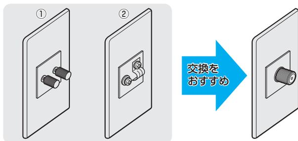
● アンテナ線のF型コネクタは、ゆるまない程度に手で締めつけてください。工具などで締めつけすぎると、壁のアンテナ端子や本機内部が破損するおそれがあります。
