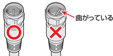
● 同軸ケーブルにF型コネクタを取付加工する場合は、芯線とアース線(網線)がショートしないようにしてください。
