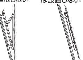
取付金具で傾けた設置や、傾斜した壁面への設置をすると、テレビが落下して、テレビの破損だけでなく、けがや床などが損傷する原因となります。
