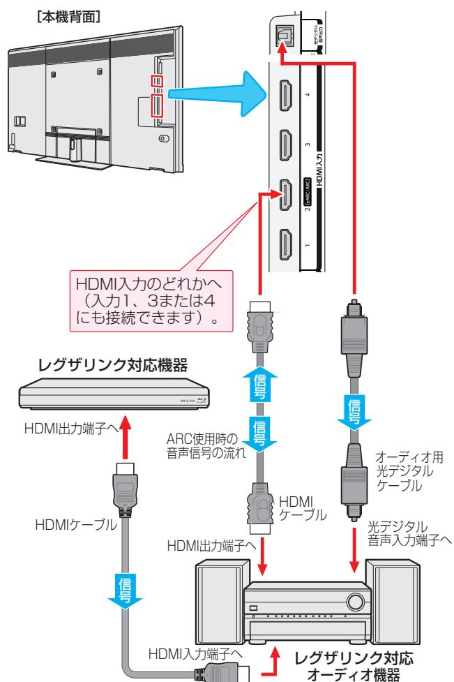
※ eARC/ARC対応のオーディオ機器を、eARC/ARC対応のHDMIケーブルでHDMI入力2(eARC/ARC)端子に接続する場合は、光デジタルケーブルの接続は不要です。
