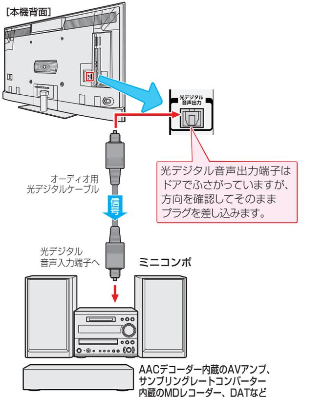
※ 光デジタルケーブルのプラグには2種類の形状があります。接続する機器の端子形状に合ったケーブルをお買い求めください。本機側に差し込むプラグの形状は、です。
