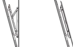
取付金具で傾けた設置や、傾斜した壁面への設置をすると、テレビが落下して、テレビの破損だけでなく、けがや床などが損傷する原因となります。
