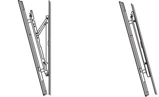
取付金具で傾けた設置や、傾斜した壁面への設置をすると、テレビが落下して、テレビの破損だけでなく、けがや床などが損傷する原因となります。
