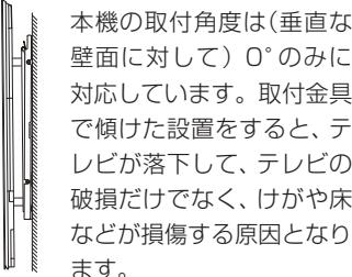
本機の取付角度は(垂直な壁面に対して)0°のみに対応しています。取付金具で傾けた設置をすると、テレビが落下して、テレビの破損だけでなく、けがや床などが損傷する原因となります。
