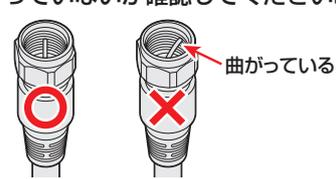
● アンテナ線のF型コネクタは、ゆるまない程度に手で締めつけてください。工具などで締めつけすぎると、壁のアンテナ端子や本機のアンテナ入力端子、背面パネルが破損するおそれがあります。
