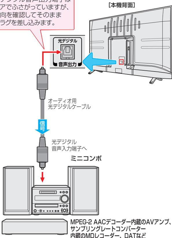
※ 光デジタルケーブルのプラグには2種類の形状があります。接続する機器の端子形状に合ったケーブルをお買い求めください。本機側に差し込むプラグの形状は、です。
