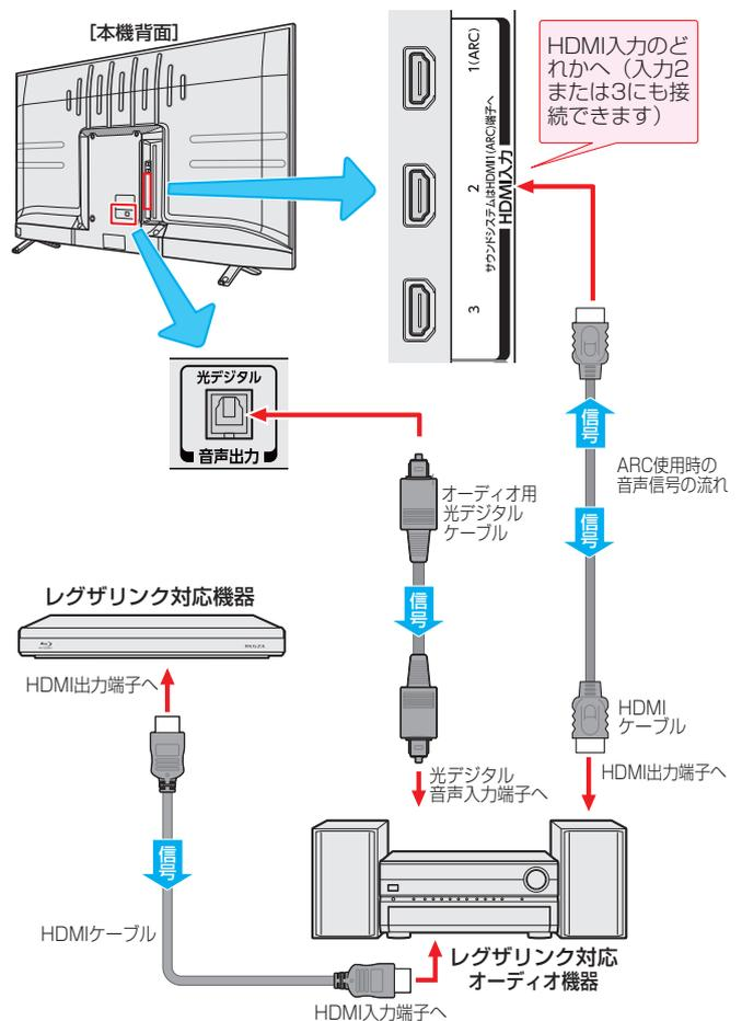
※ ARC対応のオーディオ機器を、ARC対応のHDMIケーブルでHDMI入力1 (ARC)端子に接続する場合は、光デジタルケーブルの接続は不要です。
