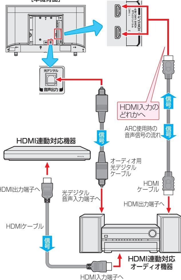
※ARC対応のオーディオ機器を、ARC対応のHDMIケーブルでHDMI入力1(ARC)端子に接続する場合は、光デジタルケーブルの接続は不要です。
